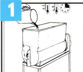
Maschine in den Nachtmodus (Stufe II) schalten oder ausschalten. Wasser einfüllen und Behälter komplett entleeren.
