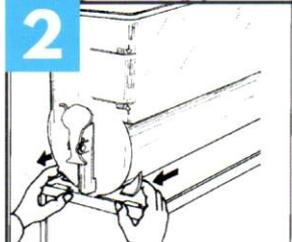
Die vorderen Halterungen der Behälter lösen und diese herausziehen. Die Außenwellenführung (rundes Plastikteil im Behälter) demontieren.
