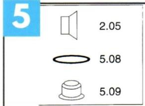
Die dargestellten Dichtungen des Zapfsystems und der Schnecke mit Vaseline einfetten.
