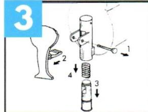
Das Zapfsystem wie dargestellt demontieren und die einzelnen Teile reinigen. Die Behälter mit heißem Wasser und Spülmittel reinigen.
