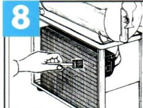
Befreien Sie den Kondensator der Maschine mit einer weichen Bürste von Staub.
