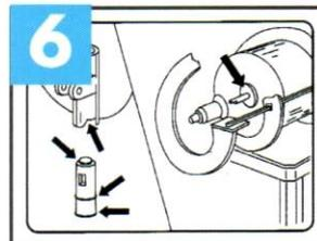
Das Zapfsystem wieder zusammenbauen und die Schnecke montieren. Die Außenwellenführung in die Halterung am Behälter einsetzen.
