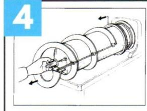
Die Schnecke vom Kühlzylinder ziehen, dann beides reinigen. Die Behälterdichtung ebenfalls säubern.
