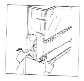
Behälterdichtung oder Behälter gut anfeuchten, dann Behälter aufsetzen und kräftig nach hinten drücken.
